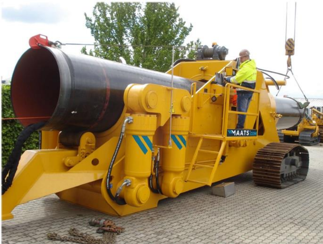
НАПРАВА НА СТУДЕНО ОГЪНАТИ КОЛЕНА С ТРЪБОГИБ (PIPE BENDING MACHINE)
